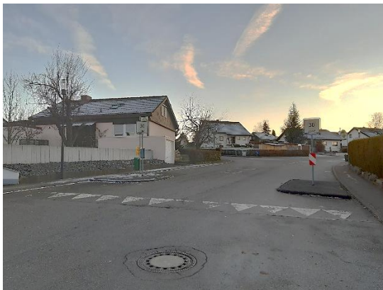
Abbildung 34: Fahrbahneinengungen bei der Einfahrt in Tempo-30-Zonen
